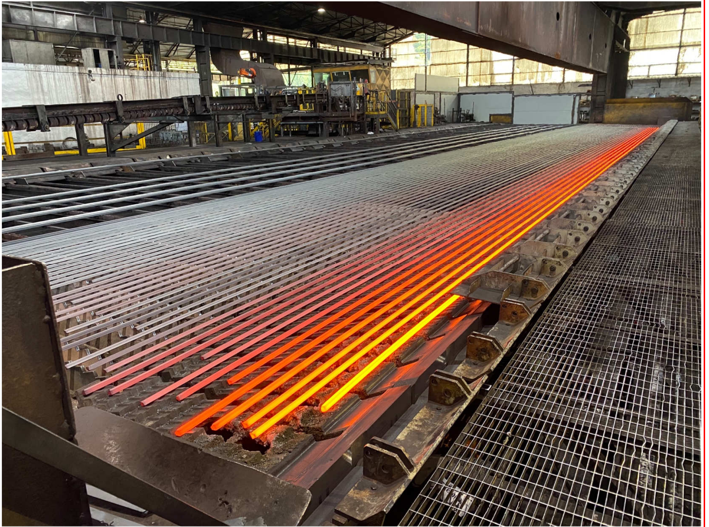
Figura 3.3.8 - Vista su placca di raffreddamento laminati lunghi
