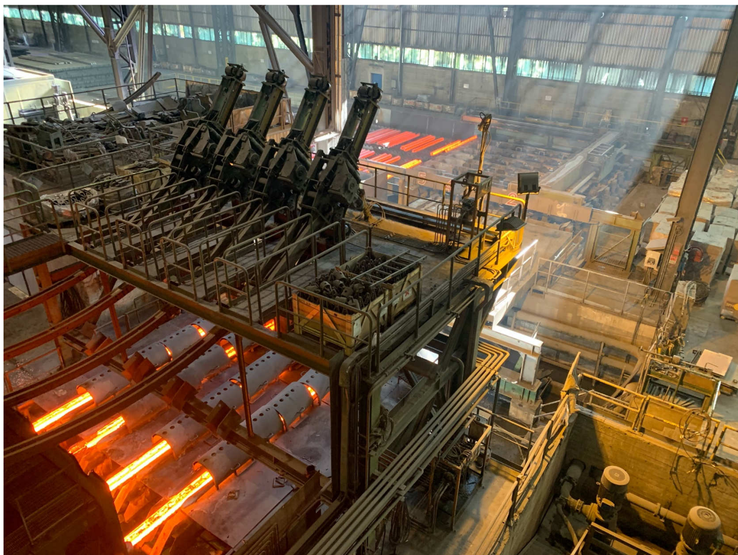
Figura 3.3.4 - Vista su colata continua del sito Acciaierie Venete di Borgo Valsugana, uno dei fornitori principali di billette per il sito di Dolcè
